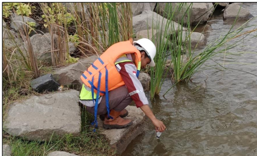
Gambar.B.2. Pengukuran pH pada saluran Inlet
