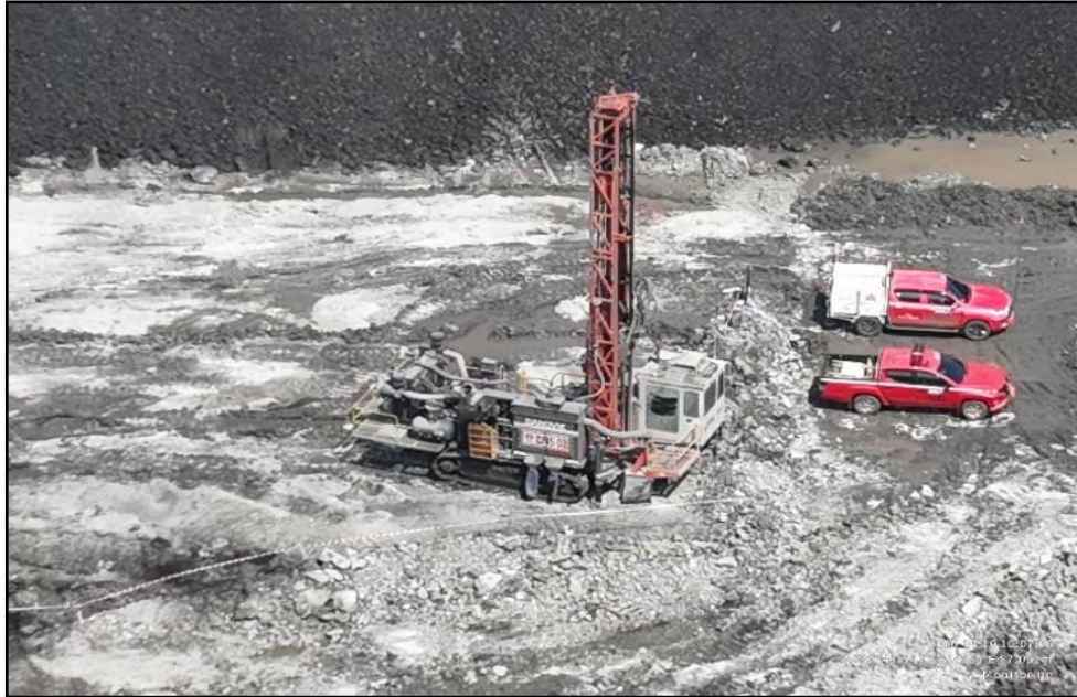
Gambar A.1 Pemboran Lubang Ledak
