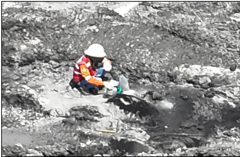
Gambar A.7 Perangkaian Peledakan
