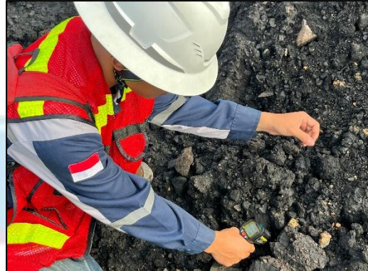
Gambar A.2 Pengukuran Temperatur pada Bagian Dasar Timbunan Batubara
