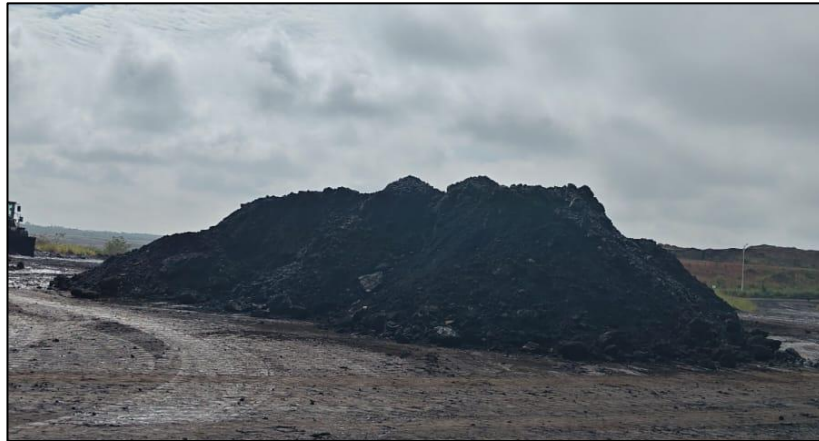
Gambar 4.2 Sistem Penumpukan Batubara Menggunakan Pola Cone ply
