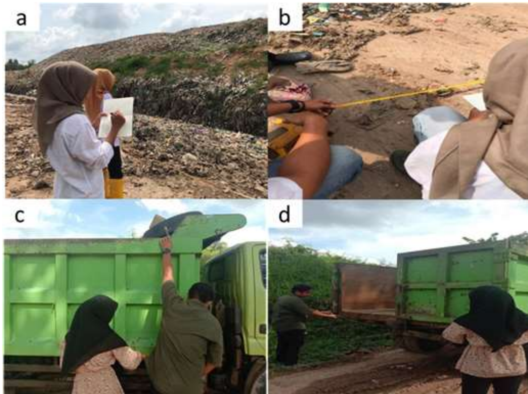
Gambar 2 Pengukuran TPA Sungai Medang dan bak truk sampah meliputi pengukuran tinggi TPA (a), pengukuran luas TPA (b), pengukuran tinggi bak dump truk (c), pengukuran lebar bak dump truk (d).
