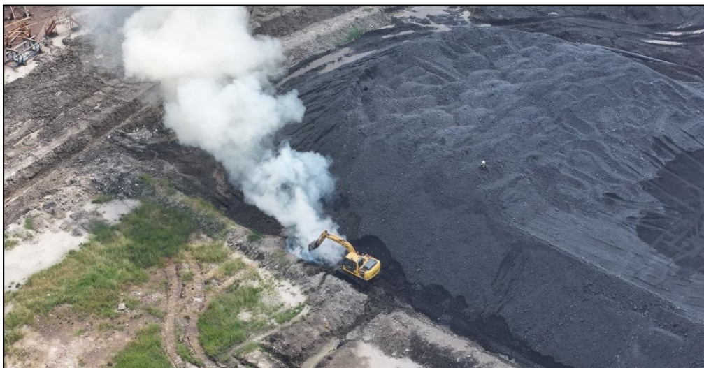
Gambar 4.5 Proses Penanganan Swabakar Oleh Excavator PC135
