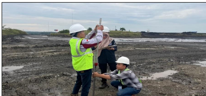
Gambar 3.8 Uji dynamic cone pentrometer Jalan AWR
