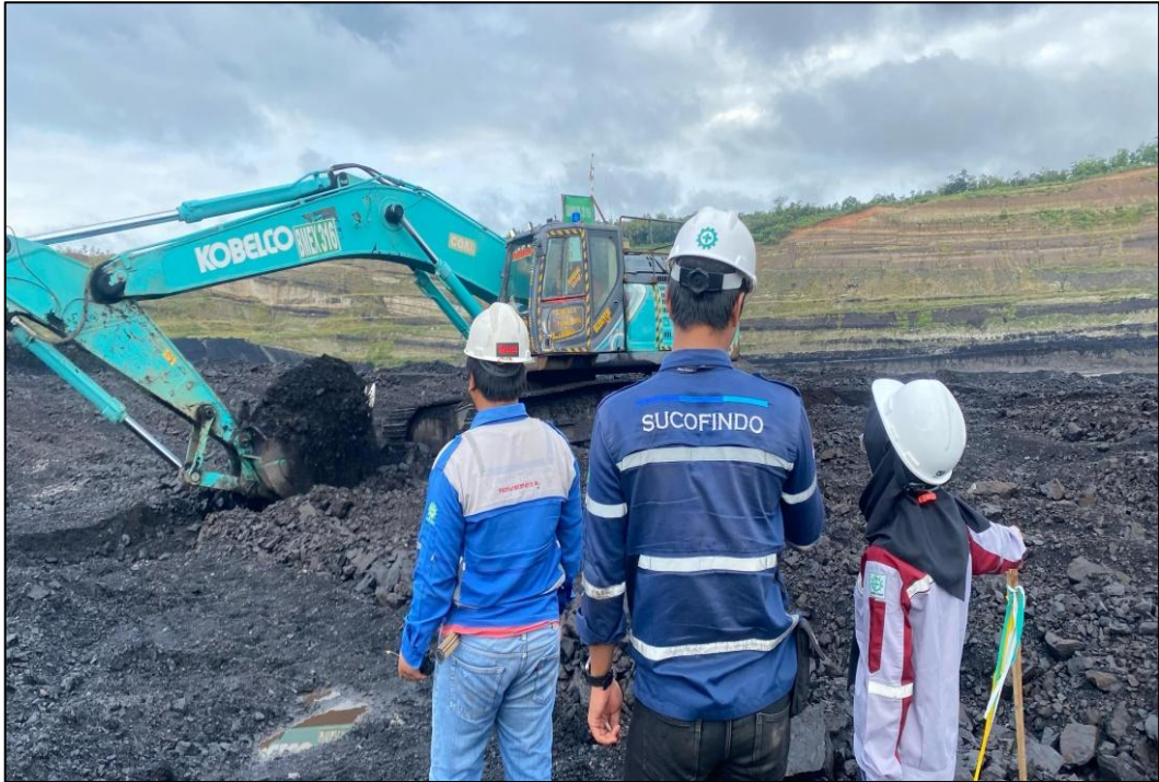
Gambar E.1 : Pembuatan Channel Oleh Excavator Untuk Pengambilan Sampling
