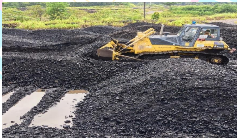
Gambar 4. 9 Genangan Air di Area Front Hasil Penambangan
