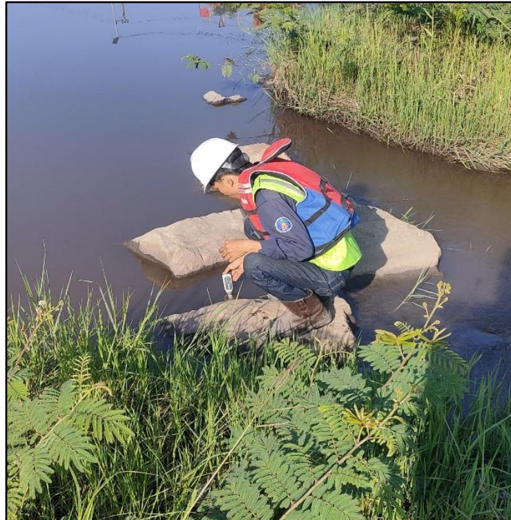
Gambar B.3. Pengukuran pH Pada Saluran Inlet
