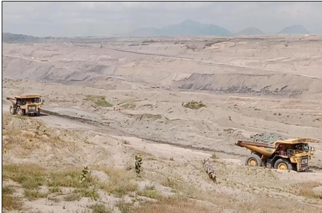
Gambar.A.5. Proses pengangkutan Overburden menuju disposal di pit Muara tiga besar utara (MTBU)
