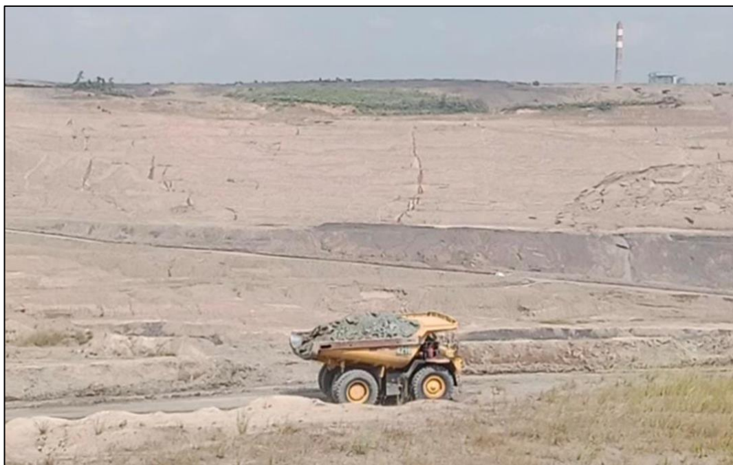
Gambar.A.6. Proses pengangkutan Overburden menuju disposal di pit Muara tiga besar utara (MTBU)
