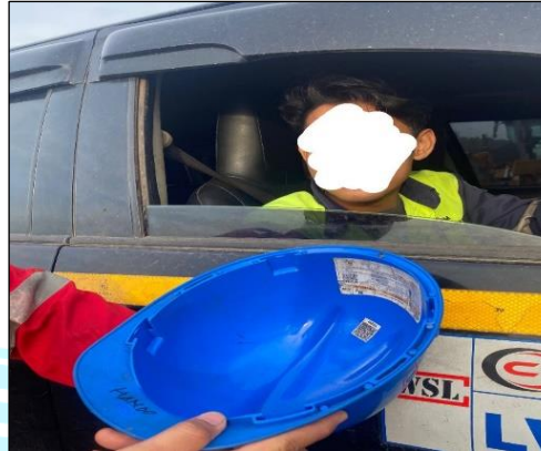
Gambar E.2 Helm tidak baik (tidak ada tali)
