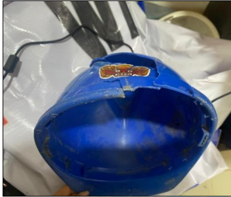
Gambar E1. Helm rusak (Tidak Layak)
