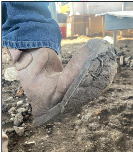
Gambar E.3 Sepatu Safety tidak layak
