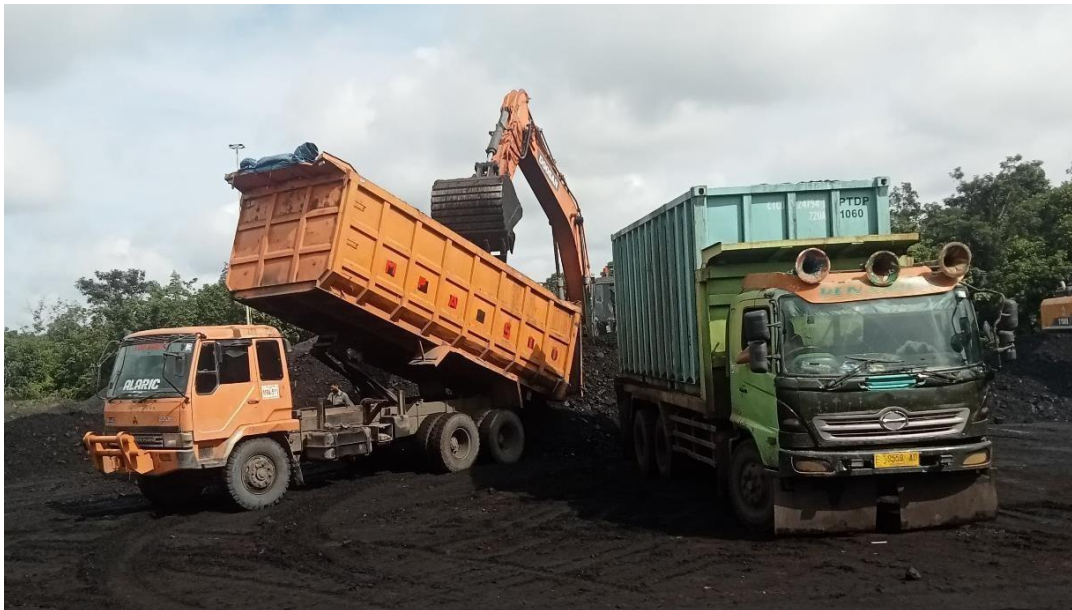
Gambar.A.4. Proses Penurunan Batubara Ke Stockpile
