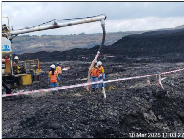
Gambar B. 4 proses pengisian bahan peledak ke lubang ledak
