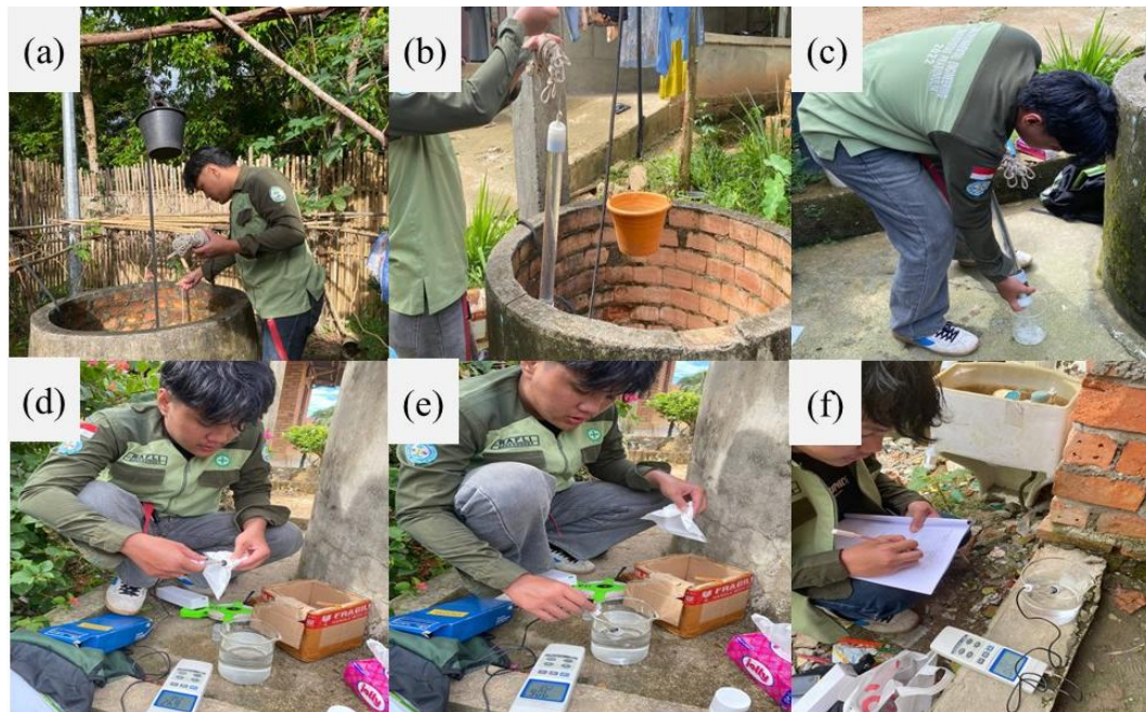
Gambar 3 Pengukuran pH air tanah meliputi pengambilan sampel air tanah menggunakan bailer (a), menarik alat pengambil sampel dari sumur gali (b), menuangkan sampel ke dalam gelas beker (c), pengeringan alat ukur menggunakan tisu (d), pengukuran pH air (e), dan mencatat hasil pembacaan parameter pH secara langsung pada lembar data lapangan (f)
