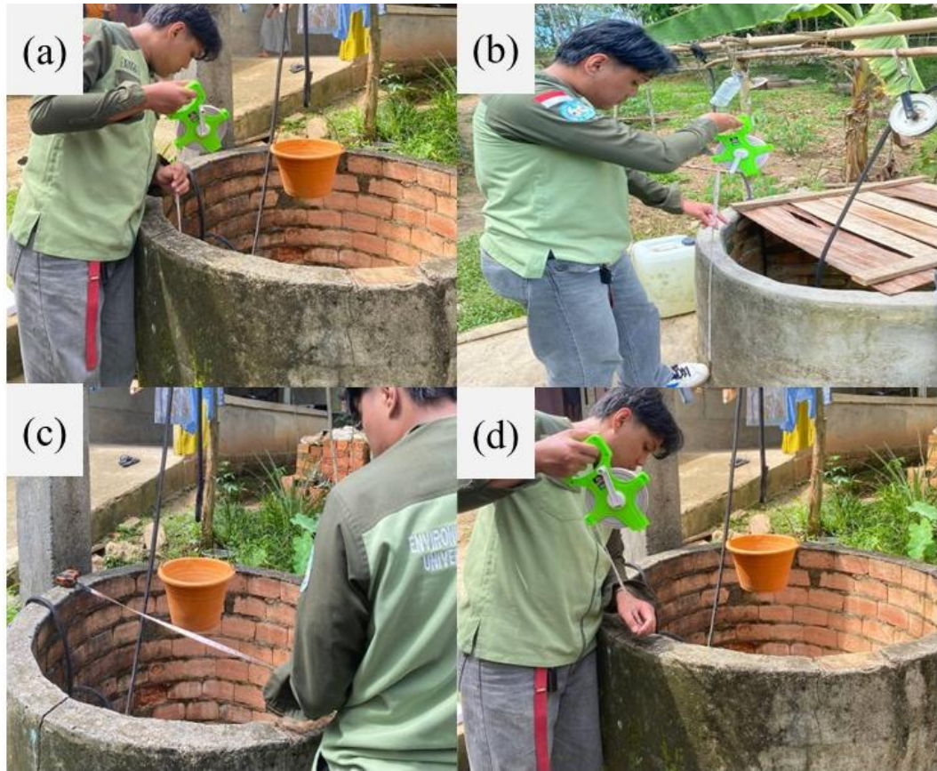
Gambar 2 Pengambilan data lapangan meliputi pengukuran kedalaman sumur (a), pengukuran tinggi dinding sumur (b), pengukuran jarak muka air tanah (c), dan pengukuran diameter sumur guna memperoleh data lapangan (d).
