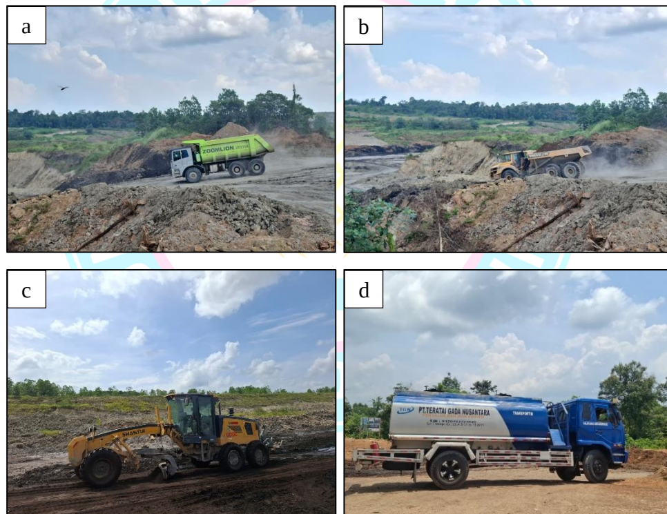
Keterangan : (a) Hauling Ob Zomlion ZT115A. (b) Hauling Ob ADT A40G. (c) Motorgrader Shantui. (d) Water Truck
