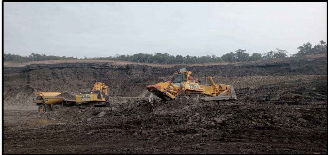
Gambar 4.3 Metode Ripping menggunakan dozer ripper Komatsu D375A-8
